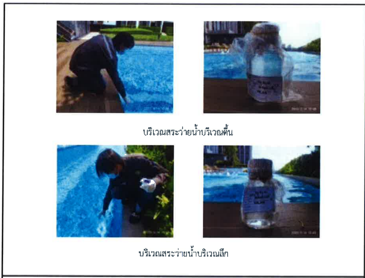
รูปที่ 3.2-3 แสดงการเก็บตัวอย่างคุณภาพน้ำในสระว่ายน้ำ
